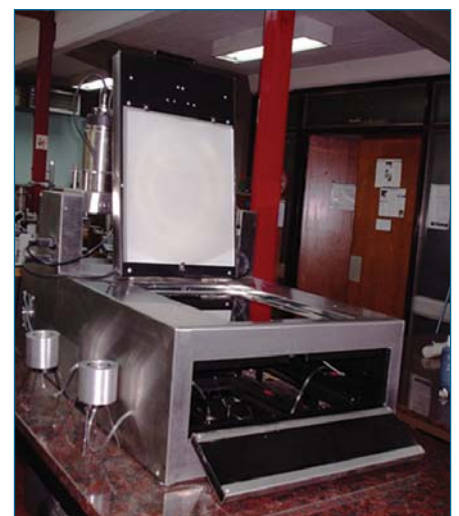
Figura 1: Muestra una imagen y una foto de un simulador experimental basado en la celda de Hele Shaw y usado en estas experiencias.
