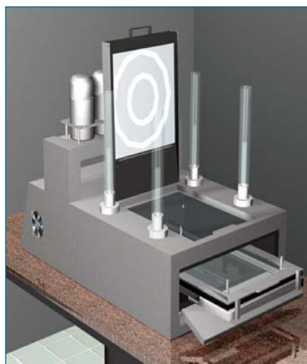
Figura 1: Muestra una imagen y una foto de un simulador experimental basado en la celda de Hele Shaw y usado en estas experiencias.
