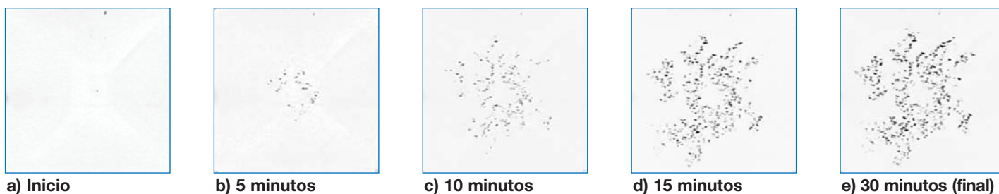
Fig. 2: Imágenes obtenidas durante el desarrollo del 1° desplazamiento. Se evidencia un posterior incremento del agua inyectada.
